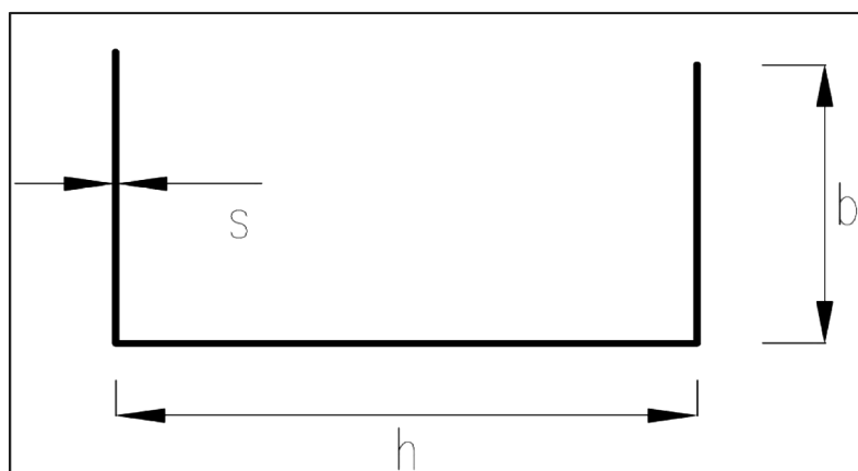
Fig. A.7. U — Profil pentru rigidizare, conform SR EN 14195:2006
